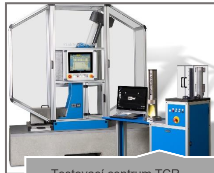
Testovací centrum TCR – komplexní řešení pro rázové zkoušky
