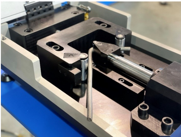
Zařízení WIREBENT pro přípravu zkušebních vzorků
